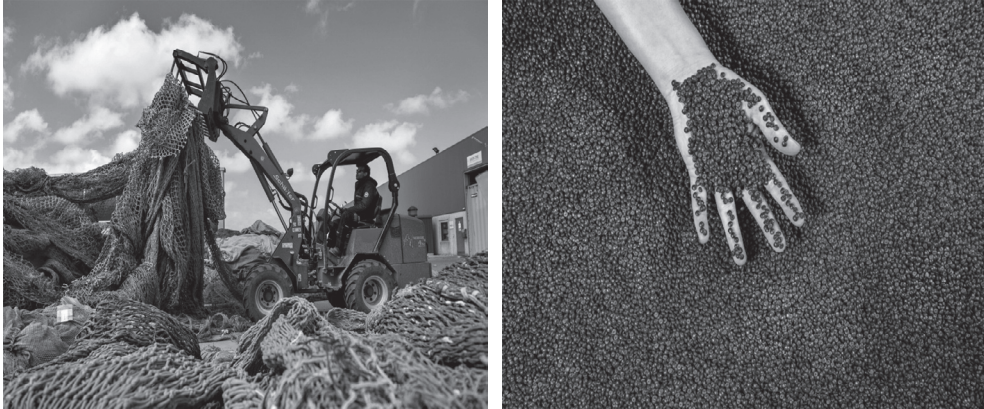
〈그림 3-17〉 폐어망을 이용해 생산된 플라스틱 알갱이
